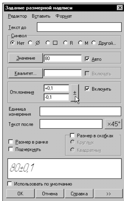
Рис. 51.110. Задание симметричного отклонения
